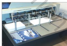
Plateau d'alimentation à succion des couvertures
